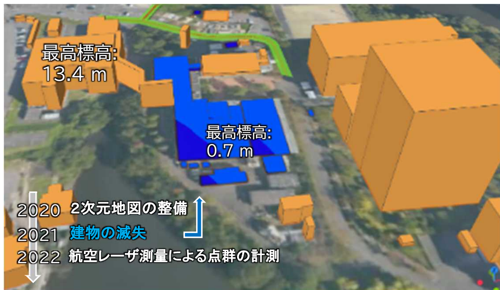
2次元地図整備時点で存在した建物が 高さデータ取得時点では存在しなかった例
