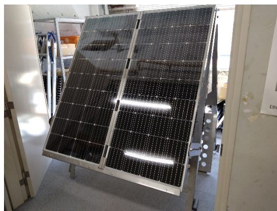
図-2 観測装置・電源バッテリー設置架台
