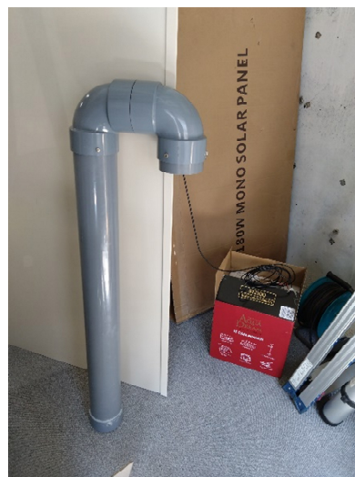
図-3 地中 MEMS 設置装置の設置後のイメージ図と製作物
