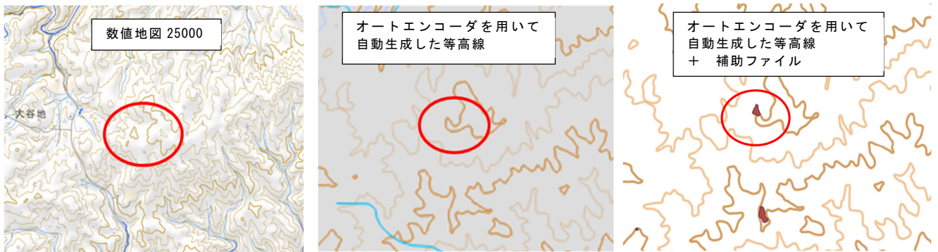
図-10 等高線が一つの領域に結合している箇所の抽出結果
