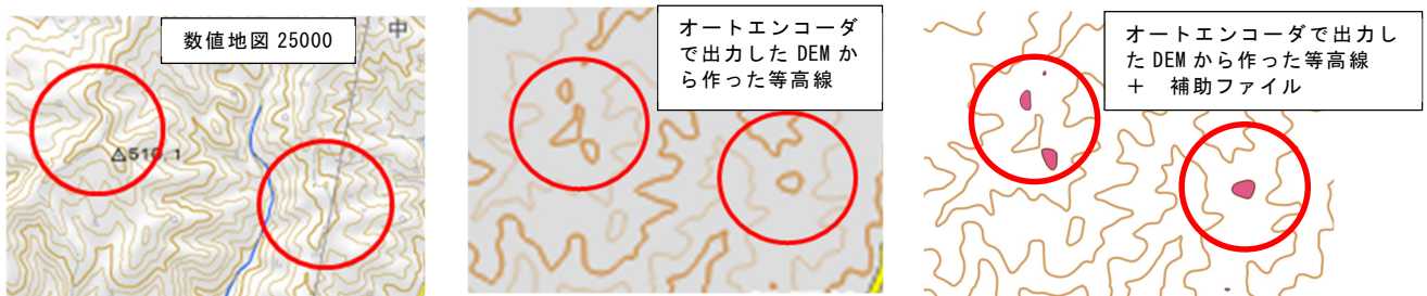
図-8 等高線が複数の領域に分割されている箇所の抽出結果
