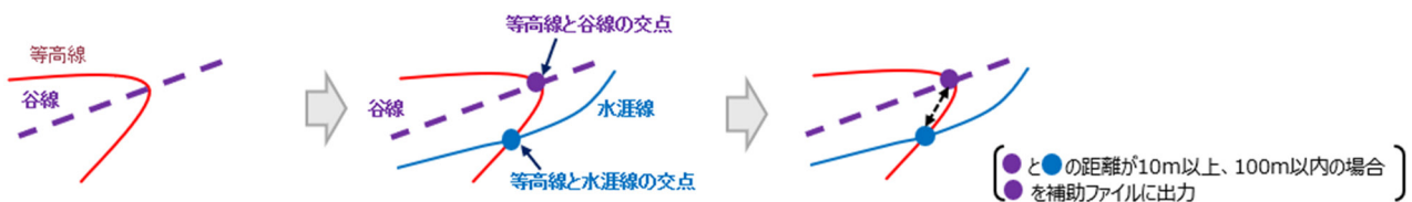
図-6 水涯線と等高線が整合していない箇所の抽出方法のイメージ図
