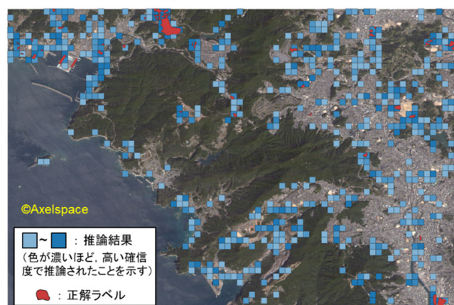
令和6年度のAIモデルにおける推論結果 (学習データ追加後, 建物新設の確信度0.5以上を表示)
