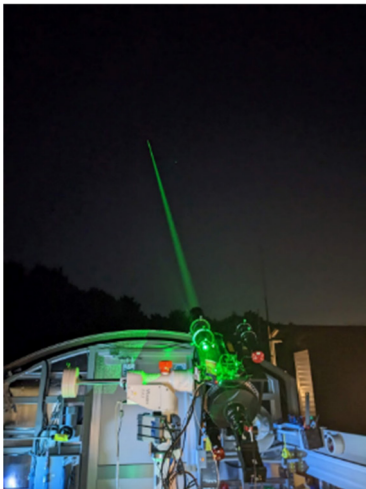
写真-5 Omni-SLR からレーザーを照射している様子（左）と、9月4日のStarlette衛星観測時におけるリターンパルスの検出時の画面（右）
