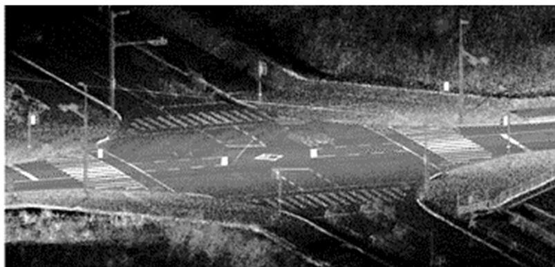
MMSで観測した三次元点群データ
