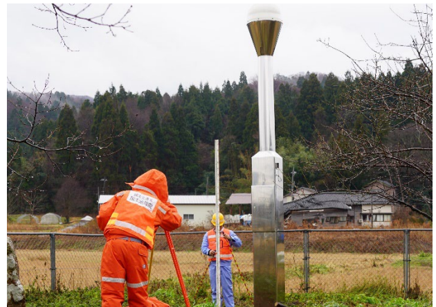
写真-4 電子基準点「輪島」の現地調査(傾斜測定)の様子
