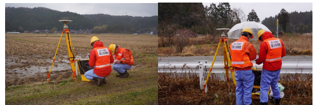
写真-8 四等三角点「貝田」(左)、「八幡」(右)でのGNSS観測(2月1日)。
