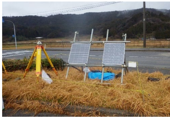
写真-5 小型GNSS観測装置「道下(とうげ)」。1月20日設置。
