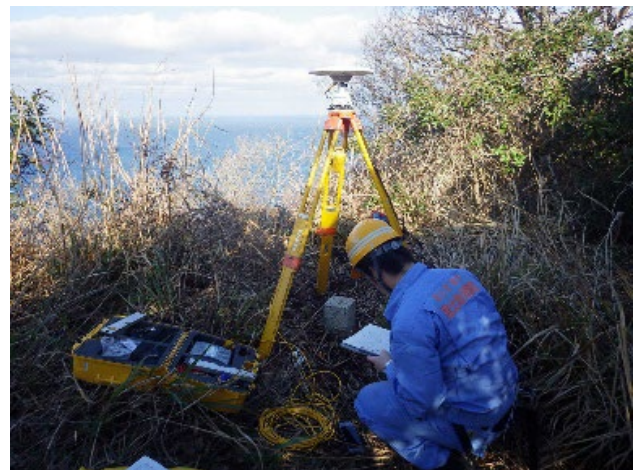
写真-2 三等三角点「五十洲」での GNSS 観測(1月20日)。
