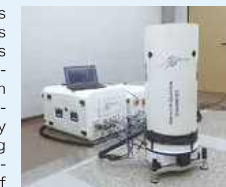
AQQ absolute quantum gravimeter
