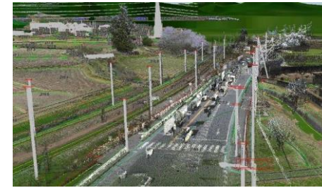
3次元構造化データ+点群データ (TINデータと点群データに画像を重ねて着色)
