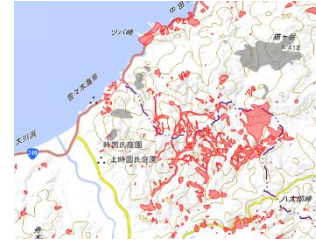
斜面崩壊・堆積分布図
