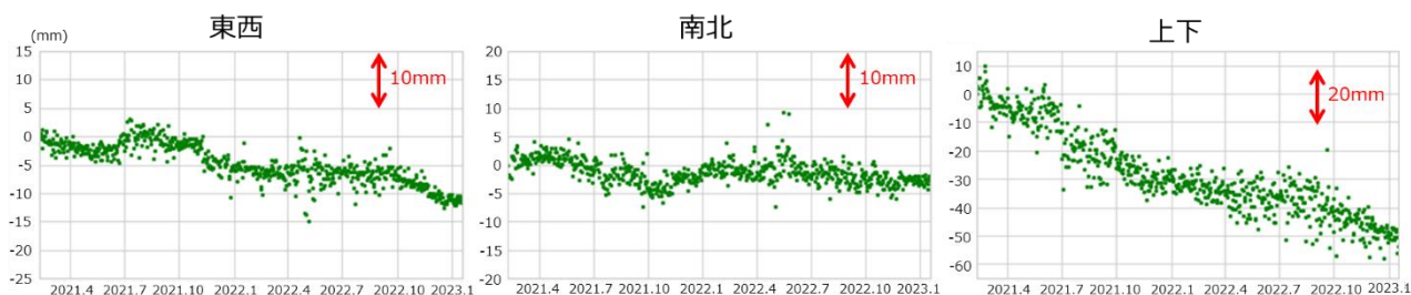
図-2 千葉県茂原市設置の小型 GNSS 観測装置の基線変化グラフ（固定点：電子基準点「白井」）
