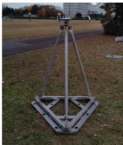
写真-2 地上用アンテナ架台
