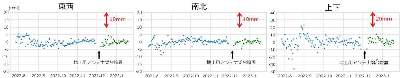
図-3 石川県珠洲市狼煙町設置の小型 GNSS 観測装置の基線変化グラフ（固定点：REGMOS）（青：GNSS アンテナを REGMOS に取付け、緑：GNSS アンテナを地上用アンテナ架台に取付け）
