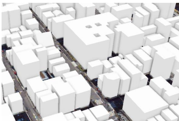
a. 基盤地図情報の建物外周線ポリゴンによるモデル
