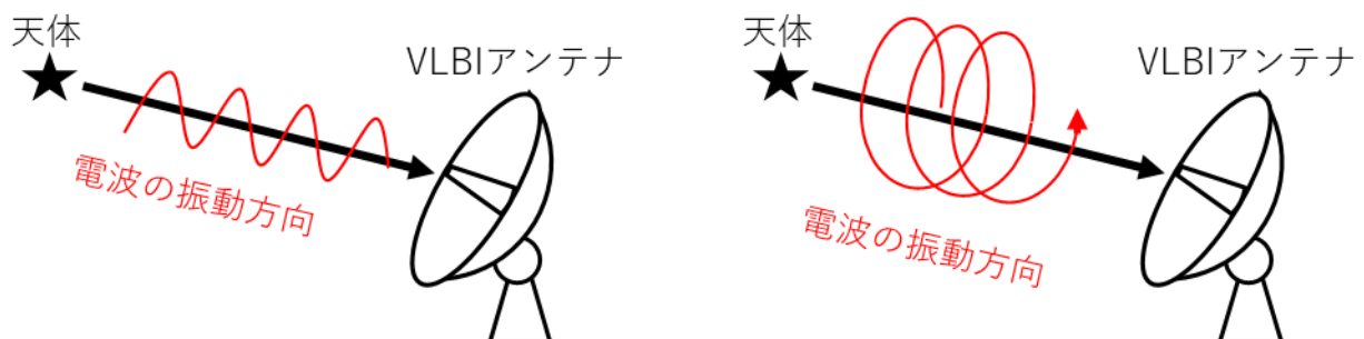
図-1 偏波の種類：左）直線偏波（水平偏波），右）円偏波（右旋円偏波）
