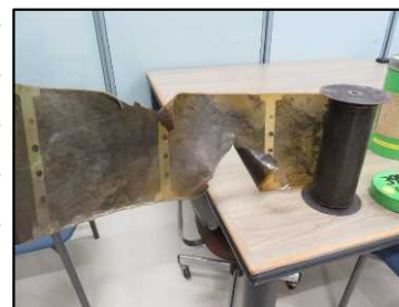
破損したフィルム
