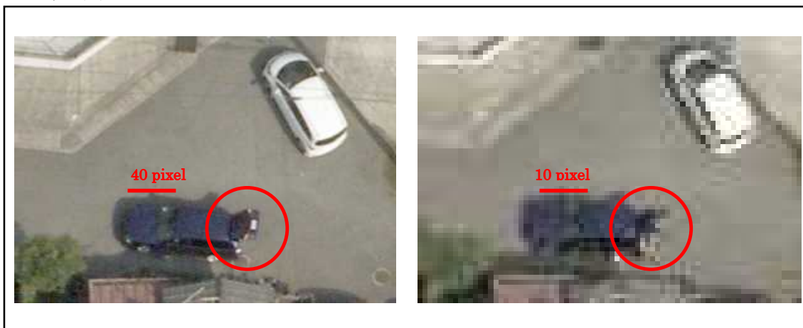
(左：地上画素寸法 5 cm、右：地上画素寸法 20 cm 図内スケール：pixel 単位、長さは 2 m 相当)
