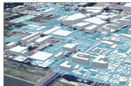
建物等の地物をデジタル空間で再現することで、高度な浸水推定が可能
