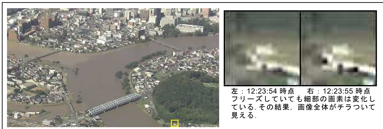
図-1 フリーズした画像の例 1（右は黄色の枠内を拡大したもの）
