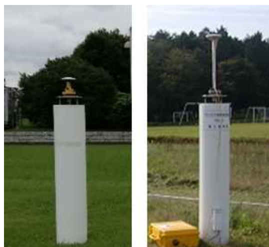
写真-1 位相特性計測の様子
