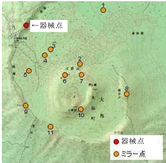
図-4 三原山カルデラにおける器械点及びミラー点の配置図
