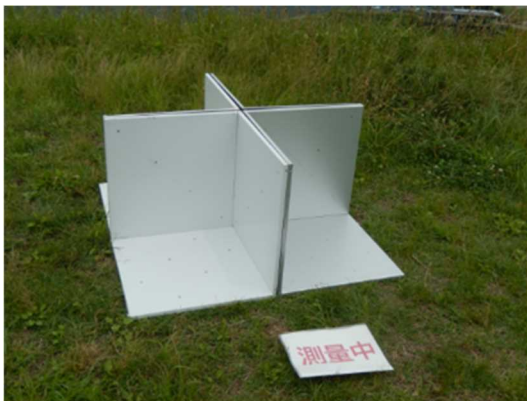
図-2 4方向に設置した4枚のコーナーリフレクタ
