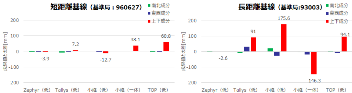
図-3 キネマティック解析結果と測量成果の較差
