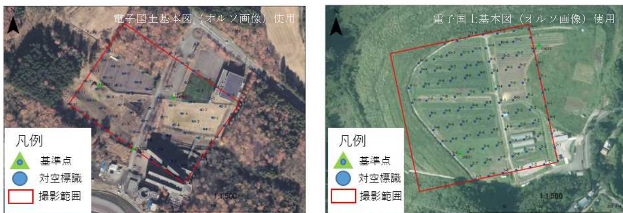
図-1 撮影範囲、標定点及び検証点配置図（左図：御殿場サイト 右図：君津サイト）
