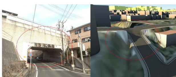
立体交差部分の3次元化の誤り (アンダーパスする道路の高さに上部の道路の高さが付与)
