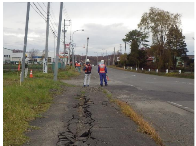
写真-2 緊急水準測量作業の観測風景
