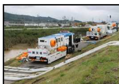
排水ポンプ車
