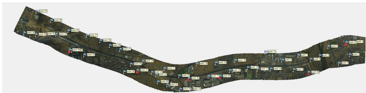
図-2 新東名高速道路伊勢原 JCT~海老名南 JCT のオルソ画像と GCP, 検証点 (赤色) の配置図
