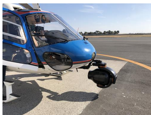
図-1 撮影に使用した防振装置 Shotover
