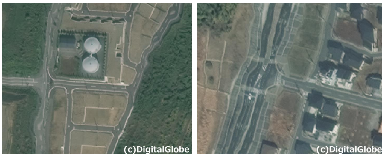
図-4 SAR-DSM を用いたオルソ画像の歪みの例
