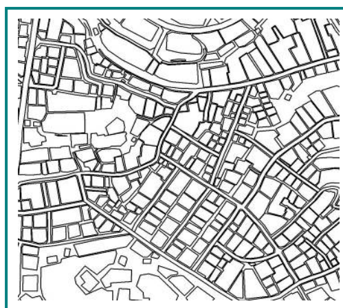
図 28 造成後人工地形の数値化イメージ (宅盤等をブレイクラインで補完取得)
