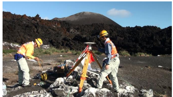
一等三角点でGNSS測量を実施（旧島には植生が確認できる）
