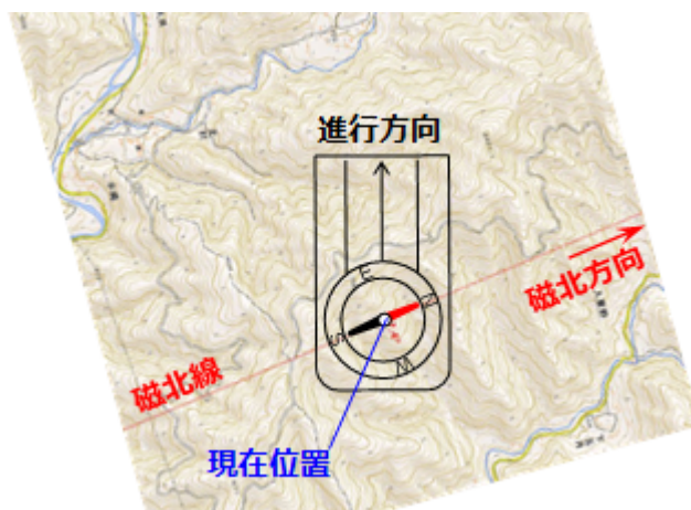
図6 磁北線と方位磁石を一致させた模式図
