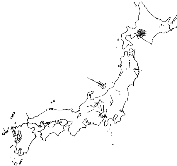
図4 重力鉛直線偏差と天文鉛直線偏差の差 (矢印) が10秒角を越えるもの (中根・黒石, 1996)
