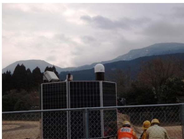
REGMOS (Remote GPS Monitoring System) は商用電源及び一般公衆回線が利用できない場所において、太陽光発電パネルで得られた電力を用いて GPS 観測等を行い、その得られたデータは高速衛星通信回線を利用して国土地理院に送信するものです。
