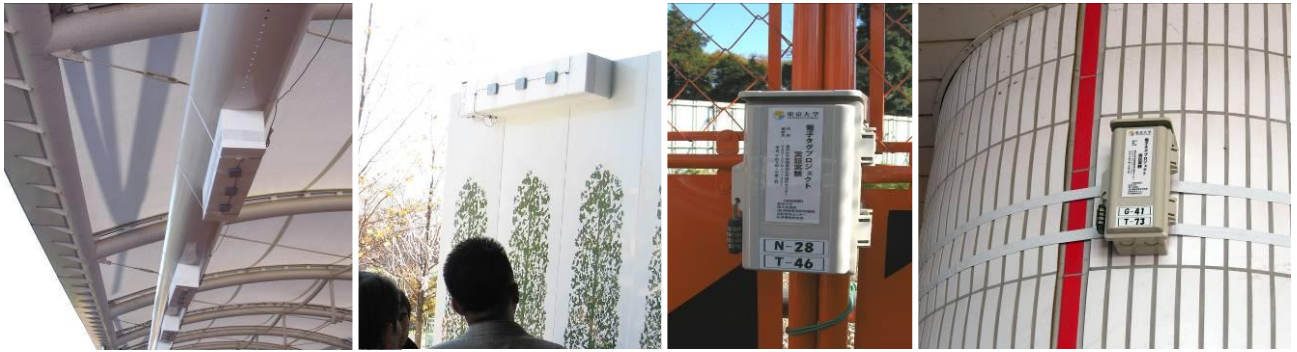
(a) コンコース 屋外用電子タグテープ (b) 自由通路 (c) 金属面 箱に格納された通常の電子タグ (d) コンクリート面
