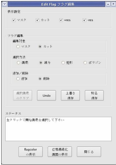
図ー1 位相データから求めた特異点を結んだカット等のFlagをGUIで編集するための画面。今回開発したSAR干渉画像位相連続化処理ソフトウェアの一部。
