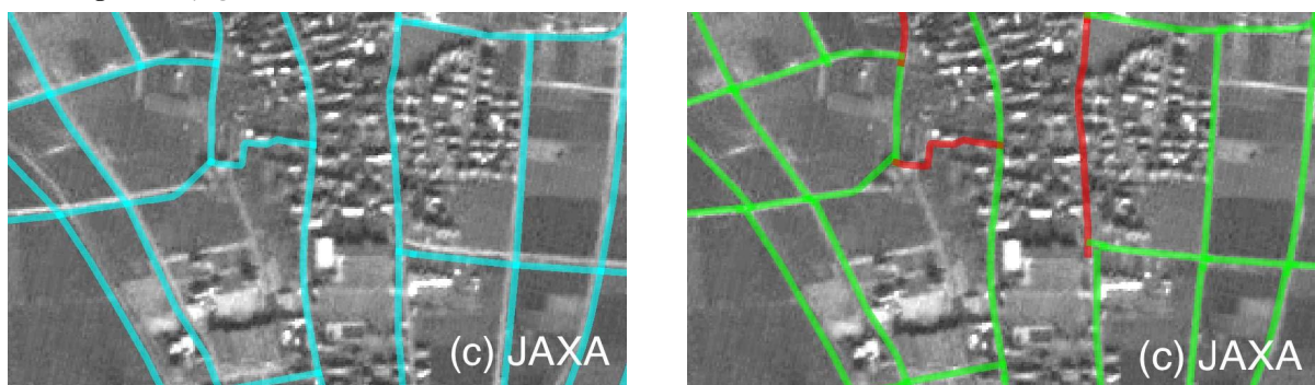
図-1 PRISM 画像と道路データの重ね合わせ (左), アルゴリズムによる検証例 (右)
