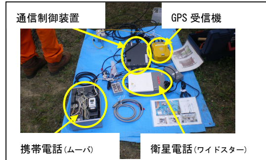
写真-2 通信制御装置等の接続
