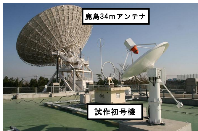
図－1 フリッジ検出試験の際の試作初号機と鹿島 34m アンテナ
