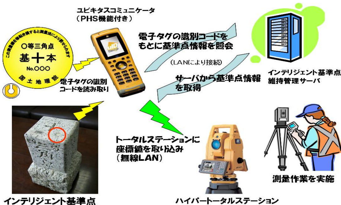
図-1 インテリジェント基準点に関するシステムの概要図
