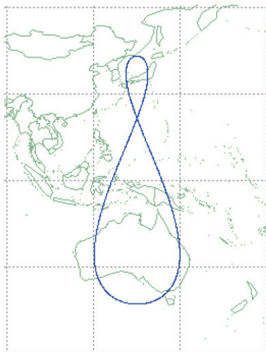
図-1 準天頂衛星の軌道の地表投影(宇宙航空研究開発機構, 2009)
