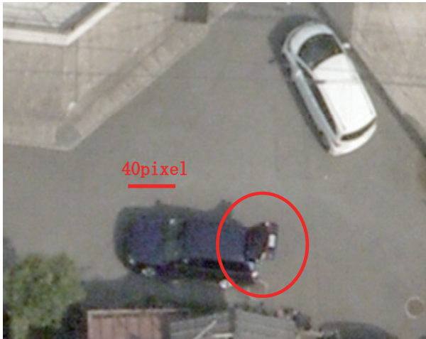
図-3 ハッチバック車両のナンバープレートの写り方 (地上画素寸法 5 cm : 図内スケールは 2 m相当)
