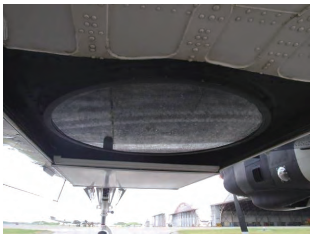
写真－3 カメラ窓のガラス部
