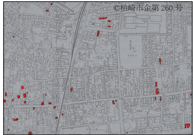
図-3 新潟県中越沖地震における倒壊家屋の抽出結果 (半壊や傾いている建物は含まない)
