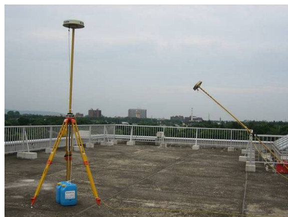
写真 - 2 アンテナを 45° 傾けた観測（写真左が北）
