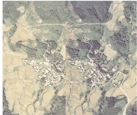
図-5 活動ブロックの斜面上部の 1/15,000 空中写真(国土地理院 1977 年撮影、立体視可能) Fig.5 Upper slope of the active landslide block shown in the stereo-pair of aerial photographs (1/15,000) taken by GSI in 1977.
