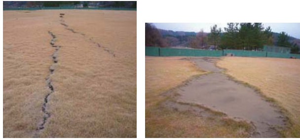
図-3 西山野球場の現地調査結果 (左) グランドの段差, (右) 外野の填砂
