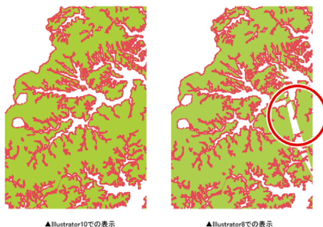
▲Illustrator10での表示 ▲Illustrator8での表示 図-1 データが壊れる例 (Ver. 8 では扱える点数が少ないため発生する現象である)
