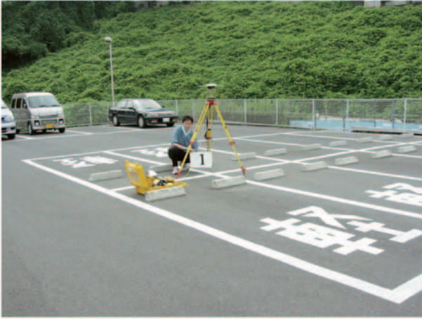
図-4 ファストスタティック GPS 測量
