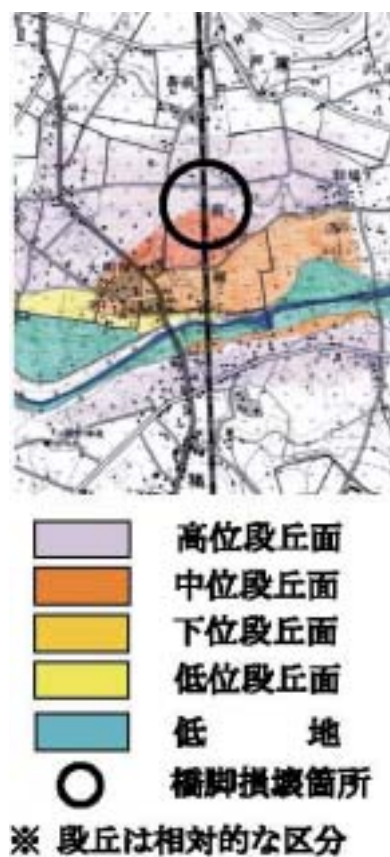
図-3 損傷箇所付近の地形分類
