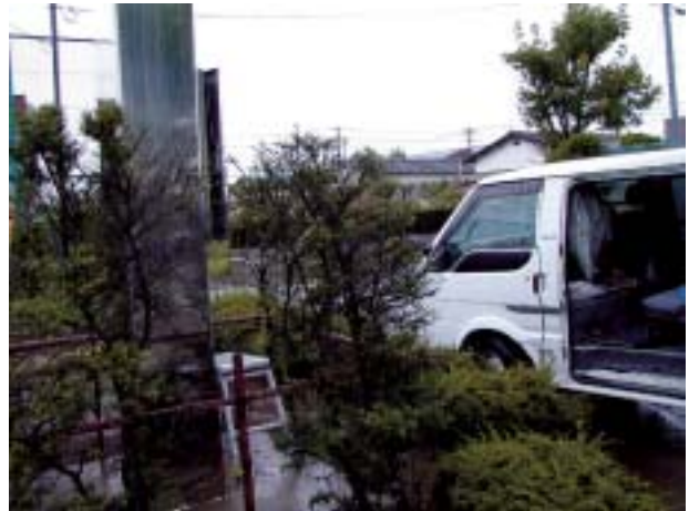
写真一2 電子基準点「矢本」。自動車から電源を取り、モデムを仮復旧（東北地方測量部）
